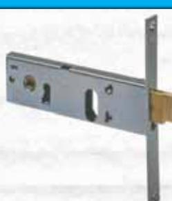
**2** Mandate. Scatola e frontale con rivestimento in zinco. Scrocco con catenaccio incorporato in ottone. Altezza scatola mm 44. Interasse mm 67. In dotazione: Viti di fissaggio cilindro e foglio istruzioni. Cilindro non incluso.
