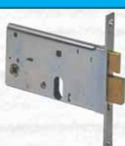
**2** Mandate. Scatola e frontale con rivestimento in zinco. Scrocco con catenaccio incorporato in ottone. Altezza scatola mm 77. Interasse mm 67. In dotazione: Viti di fissaggio cilindro e foglio istruzioni. Cilindro non incluso.
