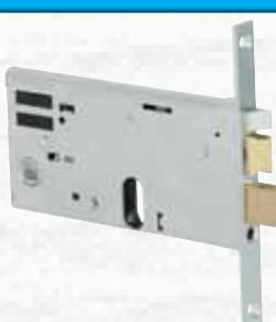
**2** Scatola e frontale con rivestimento in zinco. Scrocco autobloccante in ottone. Tensione 12V ca CE. Corrente assorbita 3,1A. Intercambiabilità fra la versione elettrica e quella meccanica. Funzione "fermo a giorno" che impedisce la chiusura del portone/cancello. Interasse mm 67. Altezza scatola mm 77. In dotazione: Viti di fissaggio cilindro e foglio istruzioni. Cilindro non incluso.
