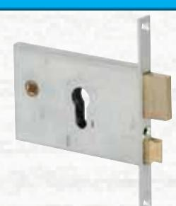
**2** Mandate. Scatola e frontale con rivestimento in zinco. Catenaccio e scrocco reversibile in ottone. Altezza scatola mm 82. Interasse mm 48. Quadro maniglia mm 8. In dotazione Viti di fissaggio cilindro e foglio istruzione. Cilindro non incluso.
