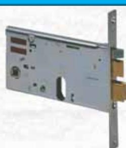
**2** Mandate. Scatola e frontale con rivestimento in zinco. Catenaccio e scrocco autobloccante in ottone. Tensione 12V ca CE. Corrente assorbita 3,1A. Intercambiabilità fra la versione elettrica e quella meccanica. Interasse mm 67. Altezza scatola mm 77. In dotazione: Viti di fissaggio cilindro e foglio istruzioni. Cilindro non incluso.
