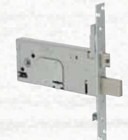
**4** Mandate. Scatola e frontale con rivestimento in zinco. Catenaccio e borchia interna in acciaio. Piastra di protezione antiscasso. Predisposizione per chiusure supplementari. Coppia boccole filettate (M8). Scrocco o scrocco/pistone reversibili nichelati. Intercambiabilità fra la versione elettrica e quella meccanica. Tensione 12V ca CE. Corrente assorbita 1,7A. Larghezza frontale 25 mm. Interasse 67 mm. 2 Chiavi in dotazione.
