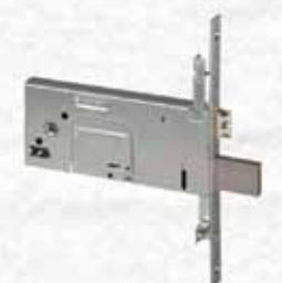
Scatola con rivestimento in zinco. Frontale in acciaio inox. Catenaccio in acciaio nichelato. Scrocco reversibile regolabile da 11 a 17 mm. Predisposizione per chiusure supplementari con perni filettati. Piastra di protezione antiscasso. Intercambiabilità fra la versione elettrica e quella meccanica. Tensione 12V ca CE. Corrente assorbita 1,7A. Frontale 22 mm. Interasse 67 mm. 4 Mandate. In dotazione 3 chiavi, Coppia borchie e viti di fissaggio.
