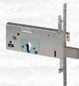
Scatola in acciaio inox. Frontale in acciaio inox. Catenaccio e scrocco reversibile. Scrocco regolabile da 11 a 17 mm. Catenaccio a 3 mandate da mm 11. Quadro maniglia mm 8. Fissaggio cilindro tramite vite all'interno della serratura. Interasse mm 67. Frontale mm 22.
