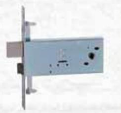
4 mandate. Frontale 25x3x240 mm in acciaio zincato. Scrocco separato reversibile. Richiamo scrocco con chiave o quadro maniglia 8 mm. Aggancio aste ad innesto. In dotazione 2 chiavi, 2 ghiere e viti di fissaggio.
