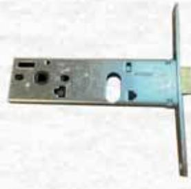
Serratura per fascia con chiusura laterale. Funzionante con cilindro ovale. Catenaccio con mandata da 9 mm con scrocco incorporato. Richiamo scrocco con chiave o quadro maniglia 8 mm. Viti per fissaggio cilindro in dotazione. Cilindro non incluso.
