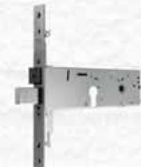
**3** Mandate da 12 mm. Elettroserratura a cilindro profilo europeo (Non incluso). Chiusura triplice. Alimentazione 12V ac/dc. Altezza cassa 64 mm. Frontale inox 240x22x3 mm. Scrocco e pistone di carica separato reversibile e regolabile. Agganci aste a vite. In dotazione: 2 ghiere, coppia spessori sottofrontale, grano interno per fissaggio cilindro e viti di fissaggio.
