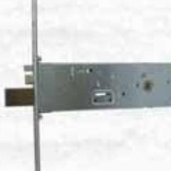
**3** Mandate da 12 mm. Serratura modulare a cilindro profilo europeo (Non incluso). Chiusura laterale. Altezza cassa 64 mm. Frontale inox 240x22x3 mm. Scrocco separato reversibile e regolabile. Possibilità di sostituire lo scrocco con il rullo o con il tappo per chiusura solo catenaccio. In dotazione: 2 ghiere, coppia spessori sottofrontale, grano interno per fissaggio cilindro e viti di fissaggio.
