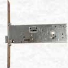
**4** Mandate da 9 mm. Serratura ad infilare modulare. Chiusura laterale. Frontale inox 240x22x3 mm. Altezza cassa 64 mm. Scrocco separato reversibile e regolabile. Possibilità di sostituire lo scrocco con il rullo o con il tappo per chiusura solo catenaccio. In dotazione: 3 chiavi, 2 guida chiave in nylon, coppia spessori sottofrontale, grano interno per fissaggio cilindro e viti fissaggio.
