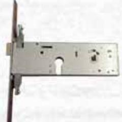
**3** Mandate da 12 mm. Serratura modulare a cilindro profilo europeo (Non incluso). Chiusura triplice. Agganci aste a vite. Altezza cassa 64 mm. Frontale inox 240x22x3 mm. Scrocco separato reversibile e regolabile. Possibilità di sostituire lo scrocco con il rullo o con il tappo per chiusura solo catenaccio. In dotazione: 2 ghiere, coppia spessori sottofrontale, grano interno per fissaggio cilindro e viti di fissaggio.
