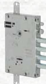
**4** Mandate. 4 Catenacci. Scrocco autobloccante richiamabile elettrificamente . Tensione 12V ca CE. Predisposizione per le chiusure supplementari. Interasse dei catenacci mm 28. Interasse mm 85. Sporgerenza mm 3,5. In dotazione 5 chiavi con 1 chiave cantiere.
