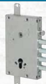
**2** Mandate. Serratura per porta blindata a cilindro applicare triplice. 4 Catenacci. Scrocco reversibile azionato da quadro maniglia e cilindro. Ambidestra. Sporgerenza 3,5 mm. Cilindro non incluso
