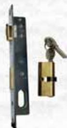
1 Mandata da 9 mm. Serratura da infilare per montanti a scatola aperta. Cilindro ovale (Non incluso). Frontale in acciaio cromato. Catenaccio prolungato 3 mm. Rullo regolabile. In dotazione viti per fissaggio cilindro.
