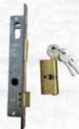
1 Mandata da 9 mm. Serratura da infilare per montanti a scatola aperta. Cilindro ovale (Non incluso). Frontale in acciaio cromato. Catenaccio prolungato 3 mm. Scrocco separato con richiamo quadro maniglia 8 mm. In dotazione viti per fissaggio cilindro.
