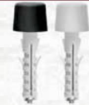
Tassello in nylon prolungato con dadino conico. Assemblato con accessori in acciaio zinato. Di grande versatilità. La particolare forma prolungata permette di eseguire anche fissaggi passanti. Idoneo per ancoraggi leggeri e medio leggeri di elementi vari (anche pensili). Dotato di alette antirotazione.
