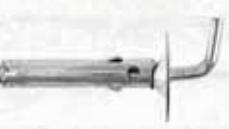
Tassello in acciaio zinato con dadino conico. Assemblato con accessori in acciaio zinato. Di grande versatilità. La particolare forma prolungata permette di eseguire anche fissaggi passanti. Idoneo per ancoraggi leggeri e medio leggeri di elementi vari (anche pensili). Dotato di alette antirotazione.
