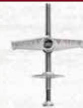
In acciaio. Per fissaggi leggeri e medio leggeri a soffitto di elementi vari (lampade, pannelli, profili). Idoneo per applicazioni a contatto, distanziate ed in sospensione su mattoni forati, pannelli incartongesso e pareti vuote in generale.
