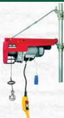
Adatto ad un uso professionale. Completo di fine corsa di discesa. L'elevatore include il tirante e i due morsetti per attacco a palo. Lunghezza fune 25 mt, Lunghezza fune 35 mt max, Peso 37kg.
