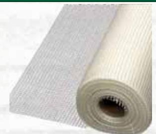
Per sistemi termoisolanti a cappotto. In fibra di vetro con apprettatura antialcalina. Maglia mm.4,1x4,1, peso 160 g/m<sup>2</sup>. Colore bianca. Conforme alla norma ETAG 004.
