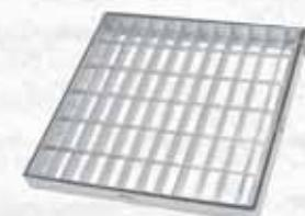
In acciaio zincata a caldo, piatto portante e bordo mm.25x2, piatto di collegamento mm.10x2, maglia mm.33x33. Telaio a 'L' spessore 15/10.
