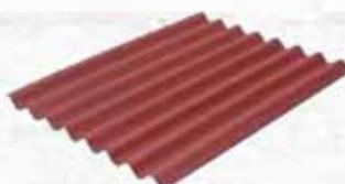
Lastre monostrato ondulata, a base di fibre organiche bitumate e verniciate nella massa con pigmenti inorganici. Spessore 2,6 mm. Numero onde: 9. Altezza onde 38 mm. Passo 95 mm. Peso 5,1Kg. Destinate alla copertura di edifici, annessi, coperture agricole, bungalow, preferibilmente con supporti in legno.
