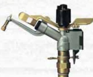
Ideale per l'irrigazione di giardini, campi da gioco, frutteti, vigneti, ortaggi e per l'irrigazione polivalente e la protezione antibrina. Costruito in ottone e Rilsan, è dotato di ugelli intercambiabili e di rompigetto registrabile. Portata massima 60 l/min. a 4 bar. Raggio di azione 17 m.
