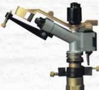
Di piccola portata, per medie e basse pressioni, dotato di ugelli intercambiabili e di un rompigetto regolabile che consente una fine dispersione del getto. È adatto per l'irrigazione di colture miste, ortaggi, fiori, frutteti, campi da gioco, e per la protezione antibrina. Portata massima 100 l/min. a 4 bar. Raggio di azione 19,5 m.
