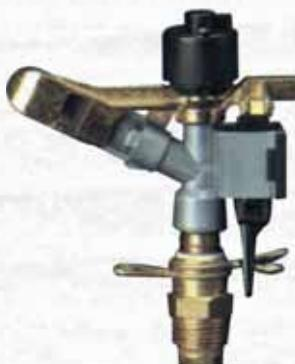
Ideale per l'irrigazione a bassa pressione di vigneti, frutteti, per la protezione antibrina. Costruito in ottone, lega leggera e delrin. Particolarmente adatto per l'irrigazione di giardini, orti e campi da tennis. Portata massima 15 l/min. a 4 bar. Raggio di azione 13,5 m.
