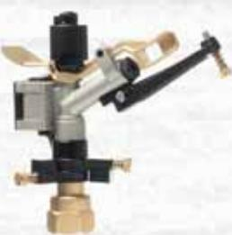
Irrigatore ad impulsi a settore con corpo in alluminio. Ideale per l'irrigazione sia a bassa pressione che a pioggia lenta di vigneti, frutteti e ortaggiere. Dotato di ugelli intercambiabili e di rompigetto registrabile ( $\varnothing 4 \div 8$  mm). Inclinazione: 30°. Portata massima 60 l/min. a 4 bar. Raggio di azione 17 m.
