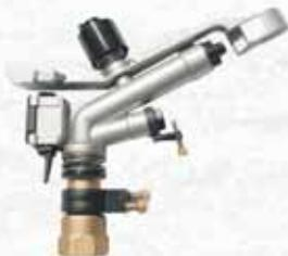
Irrigatore ad impulsi di bassa portata con doppio ugello. Adatto a piccole e medie portate. Dotato di ugelli intercambiabili e di rompigetto registrabile ( $\varnothing 5 \div 10$  mm). Inclinazione: 28°. Portata massima 161 l/min. a 5 bar. Raggio di azione 23 m.
