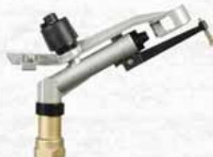
Di media portata. E' dotato di ugelli intercambiabili e di un rompigetto a penetrazione regolabile, che assicura una precipitazione fine e uniformemente distribuita. E' adatto per qualsiasi tipo di impianto e si presta per terreni di qualsiasi natura ed estensione. Portata massima 179 l/min. a 4 bar. Raggio di azione 23,5 m.
