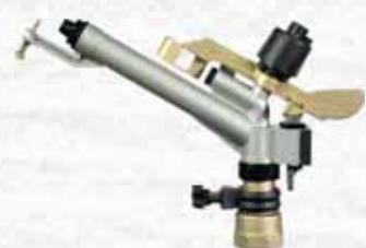
Di media portata. E' dotato di ugelli intercambiabili e di un rompigetto a penetrazione regolabile, che assicura una precipitazione fine e uniformemente distribuita. E' adatto per qualsiasi tipo di impianto e si presta per terreni di qualsiasi natura ed estensione. Portata massima 414 l/min. a 5 bar. Raggio di azione 29 m.
