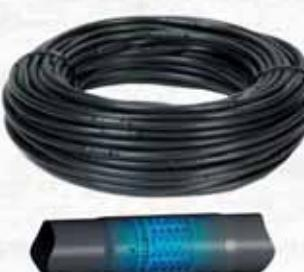
E' costituita da un tubo in polietilene con un gocciolatore incorporato. Questo sistema è ottimale per l'irrigazione di siepi, aiuole, orti, serre e colture in campo aperto. Il basso consumo idrico e la bassa perdita di carico consentono di ottenere elevate lunghezze d'irrigazione. Gocciolatore a due fori, portata nominale 2,1 l/h.
