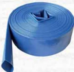
In PVC flessibile rinforzato con una rete in tessuto ad alta resistenza. Facile da tagliare e collegare, può essere forato per inserire raccordi senza rischio di infiltrazioni (unica parete). Ideale per collegamenti temporanei o per condotte che necessitano di frequenti spostamenti. Rotolo 50 m.
