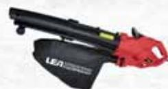
Tensione 220V/50Hz. Velocità aria 270 km/h, aspirazione max 13,5 m<sup>3</sup>/min. Selettore rapido manuale per utilizzo come soffiatore e come aspiratore. Doppie rotelle frontali di appoggio, per guidare il soffiatore sui sentieri, giardini e terreni accidentati. Sacco di raccolta in tessuto da 35 lt.
