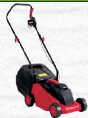
A spinta con chassis in polipropilene e larghezza di taglio di 32 cm. Tensione 230V/50Hz. Dotato di interruttore mono leva su manico ergonomico. Regolazione dell'altezza di taglio su 3 diverse posizioni da 25 a 55mm. Sacco di raccolta: 35lt. Ruote anteriori e posteriori 125mm.
