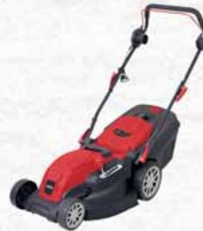
A spinta con chassis in plastica. Tensione 220/230V - 50/60Hz. Larghezza di taglio 380 mm. Cinque diverse regolazioni di taglio da 20 a 70 mm. Sacco di raccolta da 40lt. Ruote anteriori da 150 mm e posteriori da 230 mm. Peso 12Kg.
