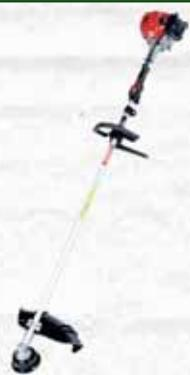
Motore a 2 tempi raffreddato ad aria, cilindrata 42,7cc, potenza 1,25kW. Capacità serbatoio 1,00lt. Rapporto miscela carburante 1:40. Avviamento a stacco. Diametro asta di trasmissione 26mm. Impugnatura a Delta. In dotazione: testina con filo nylon e lama tre denti in acciaio.
