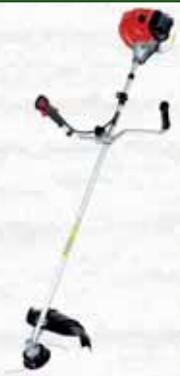
Motore a 2 tempi raffreddato ad aria, cilindrata 51,7cc, potenza 1,46kW. Capacità serbatoio 1,00lt. Rapporto miscela carburante 1:40. Avviamento a stacco. Diametro asta di trasmissione 26mm. Impugnatura girevole a 360°. In dotazione: testina con filo nylon e lama tre denti in acciaio.
