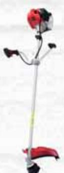
Motore a 2 tempi raffreddato ad aria, cilindrata 51,7cc, potenza 1,60Kw. Doppia impugnatura. Diametro albero: 26mm. Diametro di taglio: 255mm (Testina), 415mm (Lama). In dotazione: Testina in nylon e lama in metallo.
