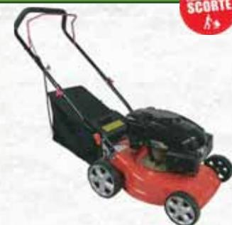
A spinta con ampiezza di taglio di 40,4 cm. Cilindrata 139 cc, 2,5 Kw. Regolazione dell'altezza di taglio su 7 diverse posizioni da 25 a 70 mm. Capiente sacco di raccolta in tessuto da 40 lt. Ruote anteriori: 152 mm. Ruote posteriori: 204 mm. Capacità olio 500 ml. Capacità benzina 1200 ml. Avviamento a strappo.
