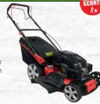
Semovente con funzione mulching e con ampiezza di taglio di 45,6 cm. Cilindrata 139 cc, 2,5 Kw. Regolazione dell'altezza di taglio su 7 diverse posizioni da 25 a 70 mm. Capiente sacco di raccolta in tessuto da 60 lt. Ruote anteriori: 176 mm. Ruote posteriori: 253 mm. Capacità olio 500 ml. Capacità benzina 1200 ml. Avviamento a strappo.
