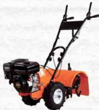
Tipo motore: OHV 4 tempi, GR-8002 (Motore RATO) Euro V; Cilindrata: 212 cc; Larghezza di lavorazione: 480 mm, Profondità di lavorazione: 175 ~ 350 mm; Cambio marcia: 0,1, retromarcia; Potenza massima in uscita: 4,1 kW / 3600 / min; Capacità serbatoio carburante: 3,6 litri; Olio capacità: 0,6 L; Peso: 70 Kg; Misure: 111x51,5x47 cm.
