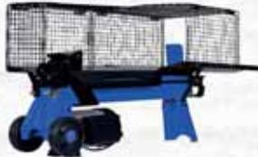
Pratico, potente e compatto. adatto anche ad essere trasportato. Motore 2200W, HP 2,95. Corsa max 52cm. Peso 55Kg. A norma EN609-1:2017
