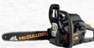
Potenza motore: 1,44 Kw/1,95 HP, cilindrata: 35 cc. Velocità di avanzamento catena: 22,8 m/s. Catena: passo 3/8", spessore 1,3 mm. Primer per avviare il circuito di carburazione e ridurre il numero di trazioni della fune di avviamento. Freno catena a doppia azione (in caso di contraccolpo, il freno arresta immediatamente la catena, in qualsiasi posizione si trovi la barra). Sistema antivibrazioni avanzato (le impugnature sono separate dal motore, riducendo al minimo le vibrazioni). Peso kg 4,6.
