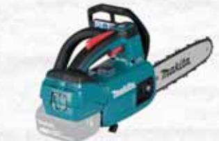
Ergonomica e maneggevole con barra a rocchetto ha una velocità della catena di 24 m/s. Il sistema XPT permette l'utilizzo in presenza di polvere e gocce d'acqua. Ideale per la sramatura e l'abbattimento di piccoli e medi arbusti. Velocità catena max (a vuoto) 24 m/s. Passo catena 3/8 / 0,325 ". Spessore catena 0,043"/1,1 mm. Numero maglie 40/46. Serbatoio olio catena 0,14 lt. Peso 3 Kg.
