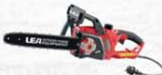
Potenza motore 2400 Watt, tensione 230V/50Hz. Catena: passo 3/8". Sistema di lubrificazione della catena automatica. Rapido sistema di tensionamento della catena con manopola. Peso 4,5kg.
