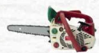
Potenza motore: 0,9Kw. Cilindrata: 25,4cc. Alimentazione: miscela. Raffreddato ad aria con carburatore Japan. Capacità serbatoio: 0,230lt. Tipo barra carving. Lunghezza barra carving: 25cm. Passo catena: 3/8", maglie 45. Emissione olio catena regolabile da apposita vite. Ideale per tutti i lavori professionali di potatura, sramatura e taglio della legna. Peso: 3,4Kg.
