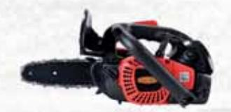
Cilindrata del motore: 18,3 cc. Potenza massima del motore: 600 W. Motore a 2 tempi alimentazione a miscela. Capacità serbatoio carburante: 170 ml. Capacità del serbatoio dell'olio: 160 ml. Ruota dentata: 8 denti x 9,53 mm (1/4 ") passo. Tipo di barra di guida: naso dentato. Lunghezza barra catena: 203 mm (8 "). Peso (con barra e catena): 2,8 kg.
