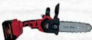
Motore Brushelles 750Watt, due batterie da 21V 4,0Ah barra 20cm con catena da 3/8"LP. Serbatoio dell'olio che permette la lubrificazione della catena manualmente mediante pressione sull'apposito pulsante. Peso con batteria: 1,950 kg.
