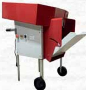
Funzionamento elettrico 220V. Potenza 350 Watt. Numero giri 2900 rpm. Produzione oraria 30 quintali/h. Base con ruote. Interruttore con protezione a norma CE. Potente ventola con regolatore di velocità in grado di separare foglie o altre impurità dalle olive. Pulisce anche altri tipi di raccolto come mandorle, fagioli, ceci, fave, granoturco, ecc. Dimensioni 61x90x105h. Peso 31Kg.
