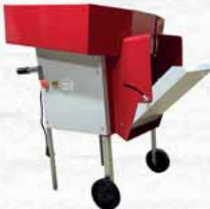
Funzionamento elettrico 220V. Potenza 350 Watt. Numero giri 2900 rpm. Produzione oraria 30 quintali/h. Base con ruote. Interruttore con protezione a norma CE. Potente ventola in grado di separare foglie o altre impurità dalle olive. Pulisce anche altri tipi di raccolto come mandorle, fagioli, ceci, fave, granoturco, ecc. Dimensioni 61x90x105h. Peso 31Kg.
