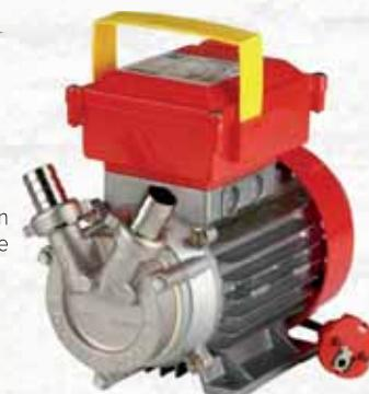
Autoaspirante bisenso. Motore monofase. Giri motore 2850 r.p.m.. Pompa in materiale inossidabile, girante in bronzo e guarnizione in Viton, albero in acciaio inox AISI 304, raccordi in ottone. E' indicata per il travaso delicato di liquidi filtrati in agricoltura, enologia, nautica e giardinaggio.
