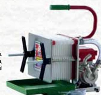
E' costituita da un'elettropompa autoadescante (che può essere utilizzata anche per i travasi del vino) e da un sistema filtrante a strati. Consente ottimi livelli di purificazione delle bevande senza alterarne le caratteristiche fondamentali ed è adeguato per filtrare vino, birra, acqua, soluzioni farmaceutiche e profumi. Funziona con 12 cartoni filtranti cm.20X20 che consentono una produzione oraria indicativa dai 350 ai 500 litri a seconda delle condizioni di impiego.
