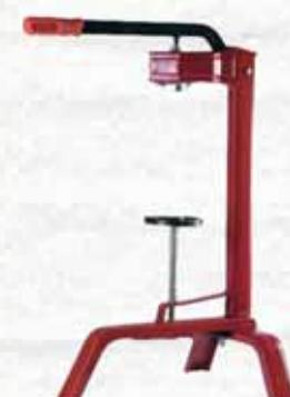
Telaio in acciaio verniciato. Per tappi in sughero e sintetici. Per bottiglie H. min./max cm 23/33.
