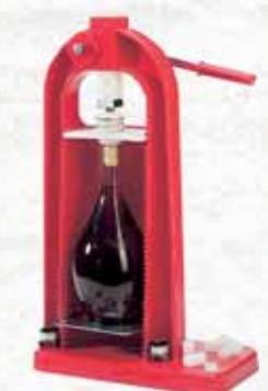
Per tappi in sughero e a corona. Corpo in polipropilene, rochetto e cremagliera in poliammide, supporto mobile e leva in acciaio zinco cromato. Si possono utilizzare bottiglie di varie misure, grazie alla regolazione in altezza del supporto in acciaio.
