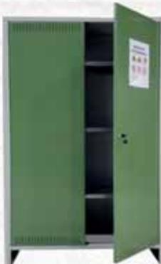
In lamiera d'acciaio. Mensole forate. Vaschetta di raccolta (per sversamento accidentale, capacità 22lt, in lamiera zincata). Sistema di aerazione. Chiusura a chiave. Segnalazione di pericolo. Conforme alle normative (D.P.R. 290/2001, Direttiva 2009/128/CE, D.Lgs 150/2012, D.M. 22/01/2014, Linea guida 26/03/2015).
