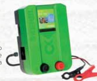
Alimentazione a pila a secco 12V e a rete elettrica 230V. Consumo 40-115 mA. Energia di scarica 1 J - 12000V. Lunghezza massima del recinto 35 km. Protezione da scarica profonda. Con Microprocessore. Chiusura ad innesto con bloccaggio a vite. Indicato per recinzioni medie senza vegetazione. In dotazione: 1 cavo di alimentazione 12V, 1 cavo di alimentazione 230V, 1 cavo di collegamento recinto/terra, 1 targhetta di avvertimento. Fornito senza batteria.
