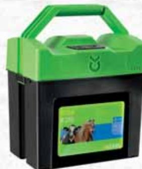
Alimentazione a pila a secco 9V. Consumo 13-19 mA. Energia di scarica 0,17 J - 9400V. Lunghezza massima del recinto 7 km. Indicato per recinzioni mobili in piccoli pascoli senza vegetazione. Ideale per cavalli piuttosto piccoli e pascoli per bovini. In dotazione: 1 cavo per collegamento recinzione, 1 cavo di collegamento alla terra, 1 targhetta di avvertimento. Fornito senza batteria.
