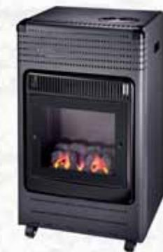
Stufa gas con carboni ed effetto fiamma molto realistica. Potenza termica: 3,4 (kW), due impostazioni di potenza 2,0/3,4kW. Massimo consumo di calore: 245g/h, minimo consumo battuto: 150 g/h. Area riscaldabile 20-80 mq. Sistema di interruzione dell'esaurimento dell'ossigeno. Con sensore antiribalzamento e ruote per facilitare gli spostamenti. Accensione con batteria (non inclusa la batteria). Senza regolatore e tubo. Adatto per bombola da 15 kg. Dimensioni del prodotto: 41x31x70 cm
