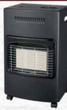
Alimentazione a gas GPL. Pannello radiante a 3 elementi ceramici. 3 livelli di riscaldamento. Accensione piezoelettrica. Dispositivo antiribalzamento. Capacità bombola del gas fino a 15kg. Consumo gas(g/h): 110(min), 210(med), 305(max). Uscita del gas(Kw): 1,5(min), 2,8(med), 4,2(max). Riscaldamento: 20-100 Mq. Pressione di esercizio(mbar): 30/37/50. Velocità ventola: 0,75/1,5W. 4 ruote piroettanti per un facile spostamento. Dimensione: mm 420x352x730h.
