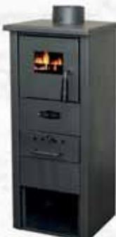
Dimensioni (L x H x P) 330x805x330 mm. Peso (kg) 30. Diametro canna fumaria 120 mm. Materiale: Acciaio. Potenza: 6,5 kW. Volume di riscaldamento (m<sup>2</sup>/m<sup>3</sup>): 35/87. Dimensione camera di combustione (L x H x P) 230x300x230 mm.
