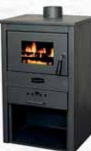
Dimensioni (L x H x P) 470x760x370 mm. Peso (kg) 42. Diametro canna fumaria 120 mm. Materiale: Acciaio. Potenza: 7 kW. Volume di riscaldamento (m<sup>2</sup>/m<sup>3</sup>): 35/91. Dimensione camera di combustione (L x H x P) 410x300x270 mm.
