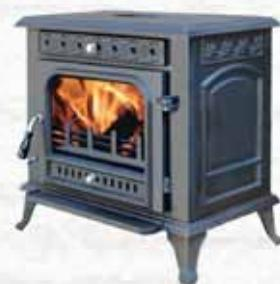
Stufa in ghisa colore nero. Potenza termica nominale 8kw. Volume riscaldabile 220 m<sup>3</sup>. Porta di carico frontale. Uscita fumi superiore e/o posteriore diam. 150. Peso 125 kg. Vetro e vernice resistente alle alte temperature. EN13240: 2001 EN13240 / A2: 2004
