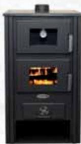
Dimensioni (L x H x P) 580x1000x470 mm. Peso (kg) 78. Diametro canna fumaria 150 mm. Materiale: Acciaio. Potenza: 12 kW. Volume di riscaldamento (m<sup>2</sup>/m<sup>3</sup>): 60/150. Dimensione camera di combustione (L x H x P) 440x370x360 mm. Dimensione forno (L x H x P) 440x220x300 mm. Lateralini in lamiera color grigio.
