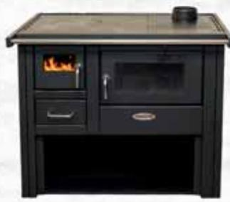
Dimensioni (L x H x P) 875x810x590 mm. Peso (kg) 82. Diametro canna fumaria 120 mm. Materiale: Acciaio. Potenza: 7,1 kW. Volume di riscaldamento (m<sup>2</sup>/m<sup>3</sup>): 40/95. Dimensione camera di combustione (L x H x P) 160x130x380 mm. Dimensione forno (L x H x P) 370x200x435 mm. Lateralini in lamiera color grigio.
