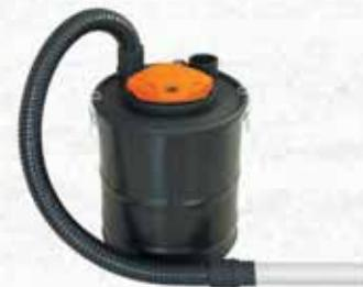
Motore 230V/50Hz, potenza 800Watt. Vacuità >15KPa. Fusto in acciaio verniciato, spessore fusto: 0,4mm. Filtro in HEPA. Tubo d'aspirazione flessibile Ø 30mm. Lunghezza tubo 2 mt. Lunghezza del cavo di alimentazione: 2mt. Accessori in dotazione: 1 Tubo d'aspirazione Ø 30mm, lancia di aspirazione in alluminio, 1 filtro HEPA e 1 pre-filtro. Ideale per aspirare la cenere fredda dei camini, delle stufe a legna o a pellet.
