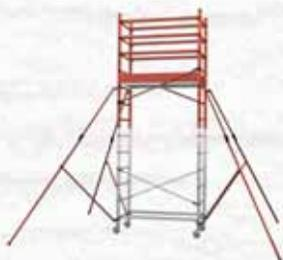
Compatibile con il codice consente di arrivare ad un'altezza di 4,10 mt. In alluminio. Comprende 2 spalle a 7 gradini, 2 diagonali, 6 traverse orizzontali, 4 stabilizzatori telescopici, 1 fascia fermapiede. Peso 35 Kg.
