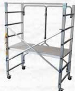
In alluminio. Speciale sistema di giunzione che permette una rapida apertura e chiusura per un facile passaggio per le porte o ascensore. Montanti mm 25x65. Piano unico. Ruote Ø 100 mm con freno. Snodo cancellotto chiudibile. Traversini quadri 30x30 mm. Blocco istantaneo delle saette con esclusive molle inox. Piano di lavoro 68x153 cm. Ingombro chiuso 21 cm. Peso 31,5 Kg.
