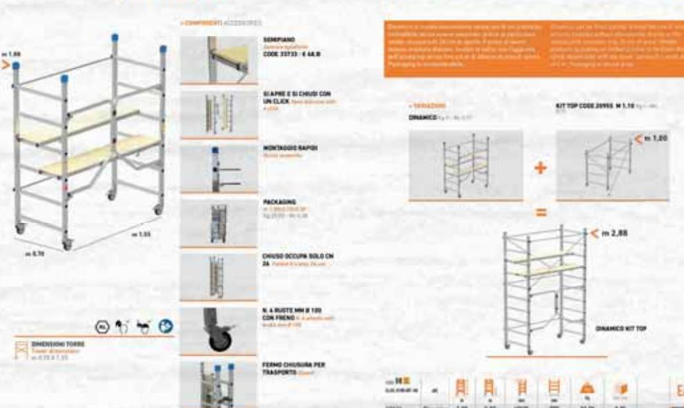
In alluminio. Richiudibile senza essere smontato, grazie al particolare snodo, occupa solo 26 cm di spazio. Il piano di lavoro doppio, montato sfalsato, facilita la salita. Dimensione torre 70x155 cm. Quattro ruote da Ø 100 mm con freno.
