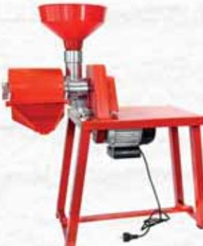
Motore asincrono monofase 230V/50Hz 4 poli, Potenza 370 Watt 0,50 HP Potenziato, Giri 1500 r.p.m. Corpo macchina e ghiera in alluminio pressofuso brillantato per alimenti, trasportatore a vite in poliammide, albero in acciaio, trasmissione con pulegge a cinghia trapezoidale, filtro in ferro stagnato, gocciolatoio in polipropilene copolimero per alimenti, imbuto e pestello in polipropilene ad alta densità, tavolo da lavoro in acciaio verniciato con polveri tipo epossipoliestere.
