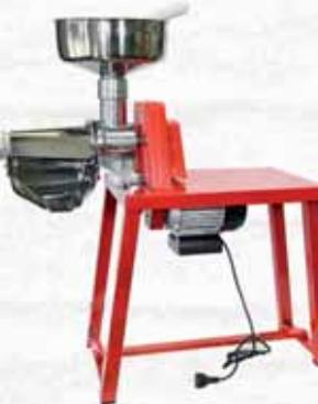
Motore asincrono monofase 230V/50Hz 4 poli, Potenza 370 Watt 0,50 HP Potenziato, Giri 1500 r.p.m. Corpo macchina e ghiera in alluminio pressofuso brillantato per alimenti, trasportatore a vite in poliammide, albero in acciaio, trasmissione con pulegge a cinghia trapezoidale, filtro in acciaio inox, gocciolatoio in acciaio inox, imbuto in acciaio inox e pestello in polipropilene ad alta densità, tavolo da lavoro in acciaio verniciato con polveri tipo epossipoliestere.
