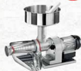
Motore asincrono monofase da 220-240 Volts/50Hz, potenza 480 Watt. Giri elica 160 r.p.m. Corpo in ghisa stagnata, tramoggia e collettore in acciaio inox, filtro in acciaio inox, basamento in acciaio inox. Incluso carter paraspruzzi.
