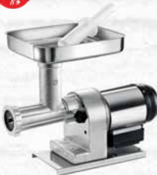
Motore a induzione asincrono monofase da 220-240 Volts/50Hz, certificato per uso continuo, potenza 480 Watt. Giri elica 160 r.p.m. Corpo, elica e ghiera in ghisa stagnata, trasmisiva e carter motore in acciaio inox, piastra e coltello autoaffilante in acciaio inox, basamento in acciaio inox.
