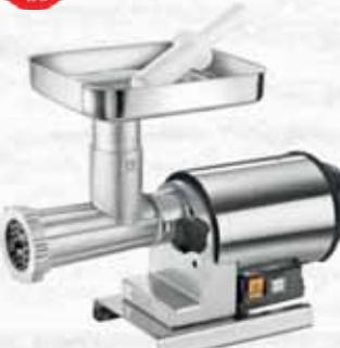
Motore a induzione asincrono monofase da 220-240 Volts/50Hz, certificato per uso continuo, potenza 600 Watt. Giri elica 80 r.p.m. Corpo, elica e ghiera in ghisa stagnata, trasmisiva e carter motore in acciaio inox, piastra e coltello autoaffilante in acciaio inox, basamento con piedini in acciaio inox.
