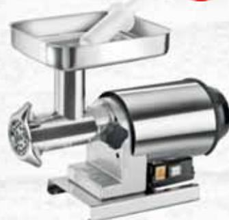
Motore a induzione asincrono monofase da 220-240 Volts/50Hz, certificato per uso continuo, potenza 600 Watt. Giri elica 80 r.p.m. Corpo, elica, ghiera, tramoggia e carter motore in acciaio inox, piastra e coltello autoaffilante in acciaio inox, basamento con piedini in acciaio inox.
