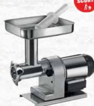
Motore a induzione asincrono monofase da 220-240 Volts/50Hz, certificato per uso continuo, potenza 480 Watt. Giri elica 160 r.p.m. Corpo, elica, ghiera, tramoggia e carter motore in acciaio inox, piastra e coltello autoaffilante in acciaio inox, basamento in acciaio inox.
