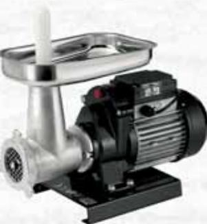
Motore ad induzione a servizio continuo con risparmio energetico a bassa temperatura. Riduttore a bagno d'olio tipo Long life (Non necessita manutenzione o sostituzione/rabbocco). Idoneo al contatto con alimenti. In ghisa stagnato. Ingranaggio metallo e nylon. Velocità di rotazione 104 g/m. In dotazione piastra e coltello in acciaio al carbonio.
