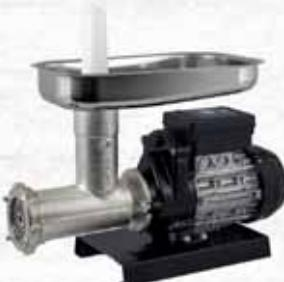
Motore ad induzione a servizio continuo con risparmio energetico a bassa temperatura. Riduttore a bagno d'olio tipo Long life (Non necessita manutenzione o sostituzione/rabbocco). Idoneo al contatto con alimenti. In ghisa stagnato. Ingranaggio metallo e nylon. Velocità di rotazione 104 g/m. In dotazione piastra e coltello in acciaio al carbonio.
