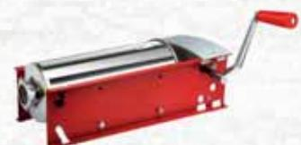
Struttura in acciaio verniciato, certificata per l'idoneità al contatto alimentare. Cilindro in acciaio inox a perfetta tenuta stagna, cremagliera in acciaio al carbonio, ingranaggi metallici antiusura, blocco riduttore in alluminio con boccole autolubrificanti, pistone in mopen corredata di guarnizione in silicone e valvola di sfato, piedini in gomma. Doppia velocità di avanzamento e rientro del pistone. In dotazione: 4 imbuti (Ø mm 10,20,30,40).
