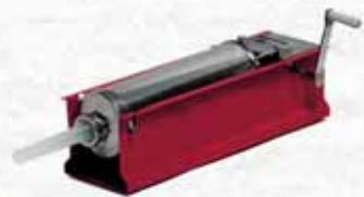
Struttura portante in acciaio verniciato con polveri di tipo epoxisipoliestere, recipiente in acciaio inox 18/10, cremagliera in acciaio, stantuffo in poliammide. La parte meccanica è composta da un set di ingranaggi in acciaio per consentire la riduzione delle due velocità. Dotata di quattro misure di imbuti atti alla preparazione di varie tipologie di insaccati.
