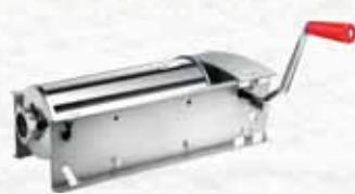
Struttura in acciaio inox. Cilindro in acciaio inox a perfetta tenuta stagna, cremagliera in acciaio al carbonio, ingranaggi metallici antiusura, blocco riduttore in alluminio con boccole autolubrificanti, pistone in mopen corredata di guarnizione in silicone e valvola di sfiato, piedini in gomma. Doppia velocità di avanzamento e rientro del pistone. In dotazione: 4 imbuti (Ø mm 10,20,30,40).
