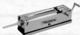
Struttura in acciaio inox AISI 430. Sistema brevettato di sfiato aria. Azionamento a varie velocità in modo da insaccare o estrarre il tampone. Perno dentato in acciaio zincato. Ingranaggio grande in zama. Cremagliera dentata a sezione quadrata in acciaio zincato. Tampone in materiale plastico per alimenti con inserto in acciaio e vite di bloccaggio in acciaio inox. Tubo in acciaio inox AISI 304. In dotazione 4 imbuti insaccatori.
