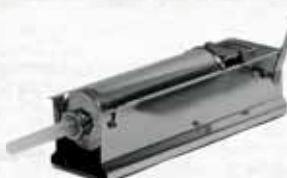
Struttura portante in acciaio inox, recipiente in acciaio inox 18/10, cremagliera in acciaio, stantuffo in poliammide. La parte meccanica è composta da un set di ingranaggi in acciaio per consentire la riduzione delle due velocità. Dotata di quattro misure di imbuti atti alla preparazione di varie tipologie di insaccati.
