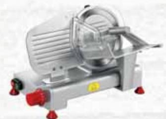
Motore asincrono monofase da 220 Volts/50Hz, potenza 110 Watt. Struttura in alluminio. Paralama, piatto e vela in alluminio anodizzato. Lama temperata, rettificata e cromata a cromo duro. Corsa carrello 21 cm, spessore taglio 0-15 mm. Ad uso domestico, ideale per affettare salumi, carni, formaggi e pane.
