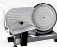
Carcassa in alluminio verniciata effetto acciaio. Lama professionale in acciaio temperata e rettificata. Premisalumi in alluminio con puntine in acciaio per alimenti. Piedini antiscivolo. Albero portalama con doppio cuscinetto. Motore professionale ventilato per funzionamento continuo. Regolazione dello spessore 0-16 mm. Dimensioni: 47x35x30 cm.
