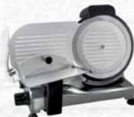
Carcassa in alluminio verniciata effetto acciaio. Lama professionale in acciaio temperata e rettificata. Premisalumi in alluminio con puntine in acciaio per alimenti. Piedini antiscivolo. Albero portalama con doppio cuscinetto. Motore professionale ventilato per funzionamento continuo. Affilatore fisso. Regolazione dello spessore 0-16 mm. Dimensioni: 53x48x38 cm.
