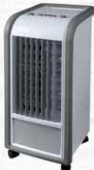
Tre velocità. Oscillazione automatica delle feritoie. Raffresca attraverso l'evaporazione dell'acqua. Tanica da 4lt. Due ghiacci sintetici inclusi. Dotato di rotelle e pratica maniglia per facilitare gli spostamenti. Alimentazione: 220/240V - 50Hz. Potenza: 65 Watt.
