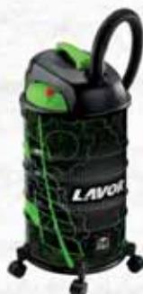
Potenza: 1200 Watt. Depressione colonna (mbar/kPa): 180/18. Portata (l/s): 35. Motore silenziato. Doppio isolamento elettrico. Sistema aspirante con raffreddamento by-pass. Funzione sofflante. Fusto in acciaio. Porta cavo elettrico. Scuotifiltro pneumatico. Cavo elettrico 4 m. Tubo flex 1,5 m. Alimentazione: 230V-50Hz. Peso: 6,5Kg.
