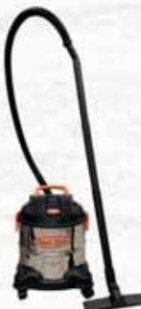
Tensione 230V/50Hz, potenza 1400Watt. Vacuità >18KPa. Contenitore in acciaio inossidabile con spessore mm 0,4 completo di 4 rotelle direzionali. Tubo d'aspirazione flessibile Ø 32 mm con lunghezza di 1,5 mt. Lunghezza del cavo di alimentazione di 2,5 mt. In dotazione: 1 tubo d'aspirazione, 1 sacchetto per la raccolta della polvere, 1 filtro in schiuma, 1 ugello interstiziale, 3 prolunghe, 1 accessorio per tappeti e pavimenti lisci.
