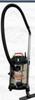
Tensione 230V/50Hz, potenza 1400Watt. Vacuità >18KPa. Presa elettrotensili max. 2000 Watt. Contenitore in acciaio inossidabile con spessore mm 0,4 completo di 4 rotelle direzionali. Tubo d'aspirazione flessibile Ø 32 mm con lunghezza di 1,5 mt. Lunghezza del cavo di alimentazione di 2,5 mt. In dotazione: 1 tubo d'aspirazione, 1 sacchetto per la raccolta della polvere, 1 filtro in schiuma, 1 ugello interstiziale, 1 prolunga, 1 accessorio per tappeti e pavimenti lisci, 1 filtro Hepa.
